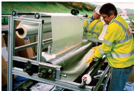
Фиг. 8.3 Сатурационна машина за SikaWrap „мокр“ метод.
