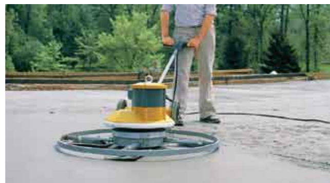
„Хеликоптер“ с променлива скорост на шлайфане за завършване на бетонни и полимерни подове
