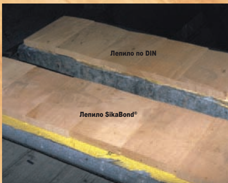
Фиг. 5 Изпитване в екстремни условия: Масивна букова дъска с дебелина 21 mm, 22 % съдържание на влага в дървото
