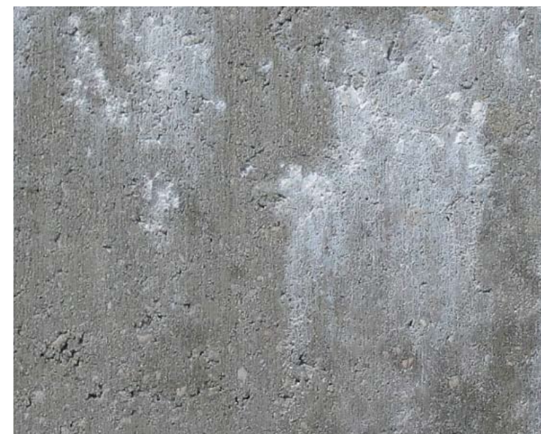
Съществено редуцираната водна абсорбция със SikaPaver® AE намалява риска от ефлоресценция.
