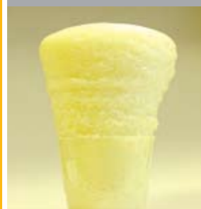
Степента на свободно разширение на Sika® Injection-101 RC е до 40 пъти.
